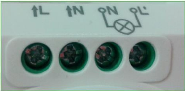
Bornas para la conexión del cableado.
